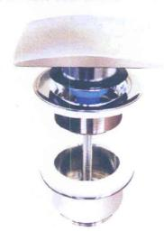
L'innovativo sistema di scarico "Stop&Go" brevettato della VALPRA si distingue dai comuni scarichi con il cavo di trasmissione per la facilità con cui viene azionato il meccanismo di apertura e chiusura del tappo: con due semplici gesti di pressione si chiude (stop) e si apre (go).
