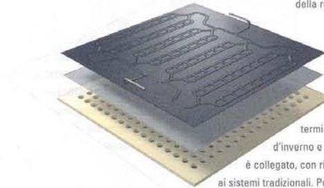
**VERSATILE** Climacustic è una perfetta combinazione tra una piastra a irraggiamento termico e un pannello fonoassorbente che riscalda d'inverno e raffresca d'estate grazie alla pompa di calore cui è collegato, con risparmi rispettivamente del 30% e del 40% rispetto ai sistemi tradizionali. Può essere installato a parete o a soffitto. Le lastre hanno dimensioni 60x60 o 60x120 cm in diverse finiture e personalizzazioni.
